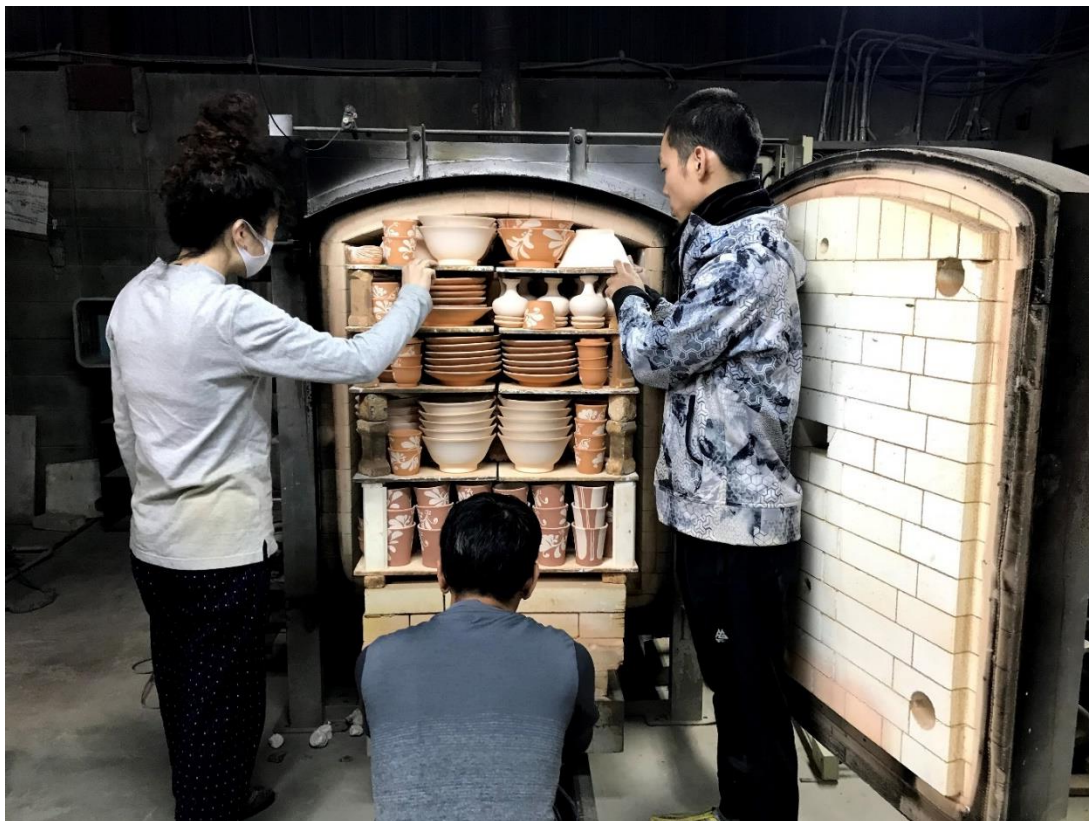
工房 T での作業風景：素焼き出し（2021 年 2 月 11 日筆者撮影）
